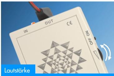
Maximum empfohlen für Hörtest. Betrieb mit Grundrauschen auch bei Minimum-Einstellung. **Audio-(IN)-Signale werden vom Minimum-Anschlag ausgehend ab einer halben Bogenlänge zunehmend wahrnehmbar.** Lautstärke Steigerung hat geringen Einfluss auf den Stromverbrauch.
